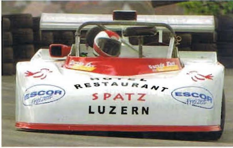
328 Tiga SC 80 Rennsportwagen 1980 Motor: Ford BDA 1600 1600 ccm, 245 PS, 4 Zylinder Armando Krummenacher Luzern
