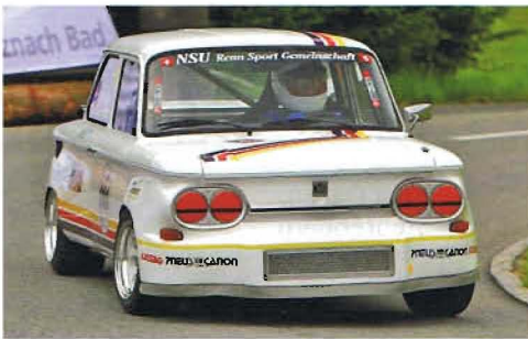
217 NSU TT 1200 Spezialtourenwagen Gr. 5 1972 1260 ccm, 90 PS, 4 Zylinder
