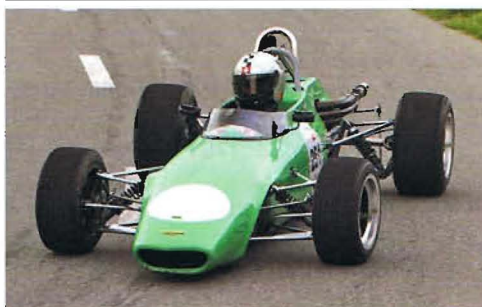
354 Chevron B 17 Rennwagen Formel 3 1000 1970 Motor: Ford Novamotor (Anglia) 1000 ccm, 115 PS, 4 Zylinder
