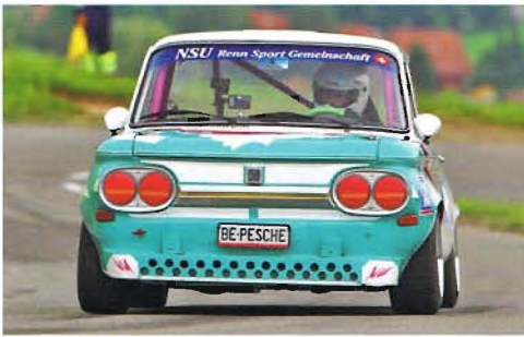
216 NSU TT 1200 Spezialtourenwagen Gr. 5 1968 1177 ccm, 85 PS, 4 Zylinder
