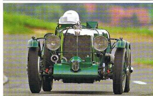
108 MG K3 Sportwagen 1935 1087 ccm, 83 PS, 6 Zylinder Kompressor
