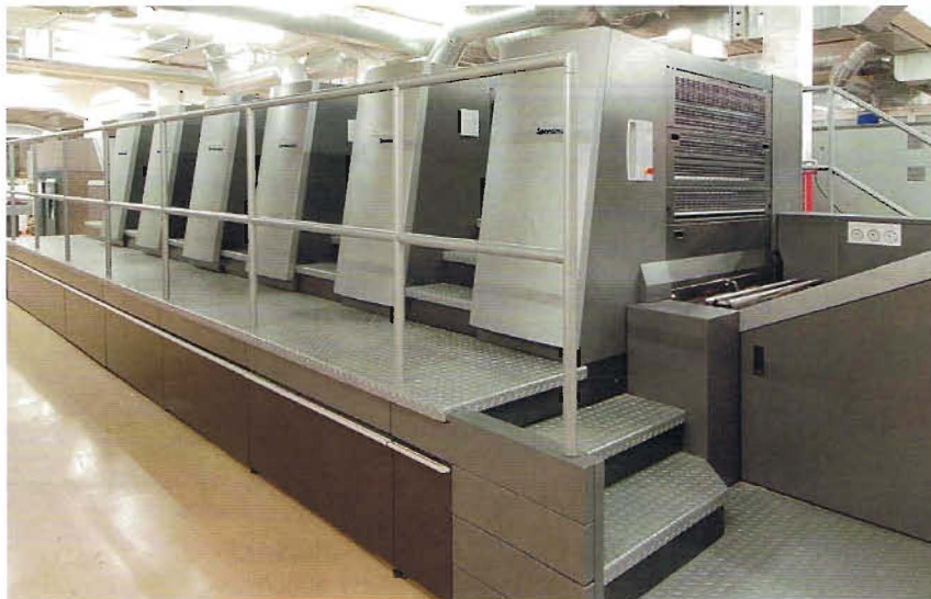
Neuste Drucktechnologie: Heidelberg XL 105, 18000 Bogen/h
